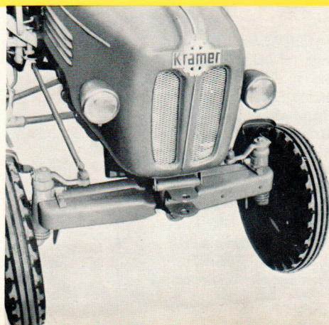
Noch bessere Bodenhaftung und höhere Zugkraft erhalten Sie durch die schnell und leicht anzubringenden Belastungsgewichte am Vorderachsträger.
