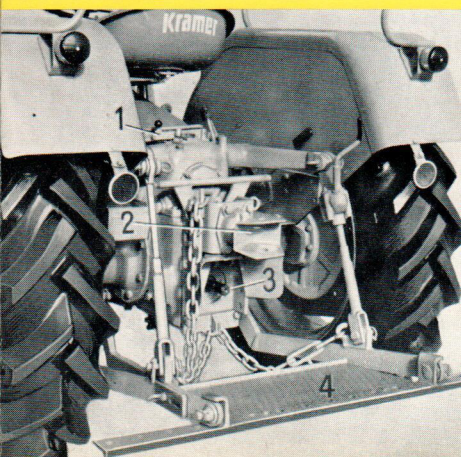
1. Differentialsperre, jederzeit schaltbar. 2. Die dreh- und höhenverstellbare Anhängerkupplung; abzuklappen für Arbeit mit Geräten, daher praktisch bei Arbeitswechsel. 3. Zapfwelle. 4. Blechplatte.
