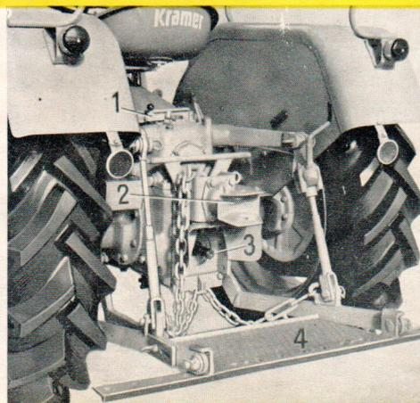
1. Differentialsperre, jederzeit schaltbar. 2. Die dreh- und höhenverstellbare Anhängerkupplung; 3. Zapfwelle. 4. Blechplatte.
